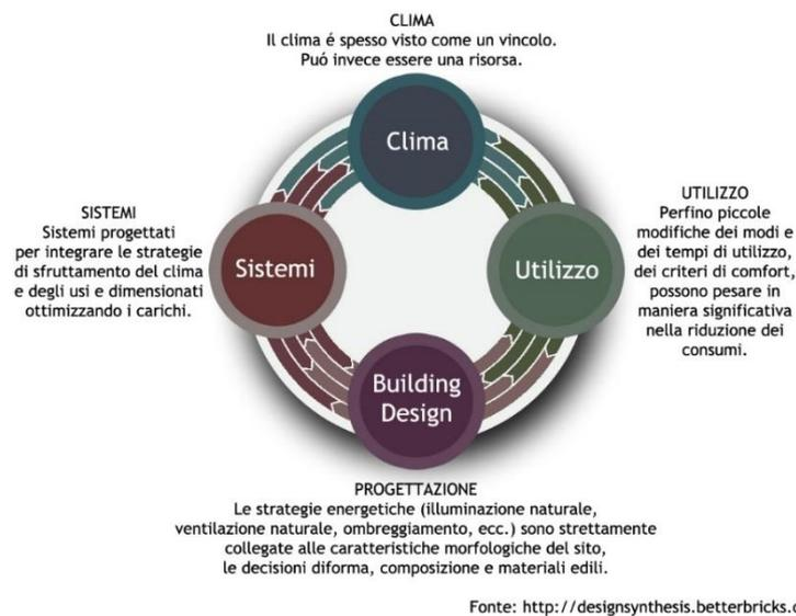
**Figura 9: Progettazione energetica integrata. Fonte: 'Integrated Energy engineering & performance modeling into the design process' [12]**
